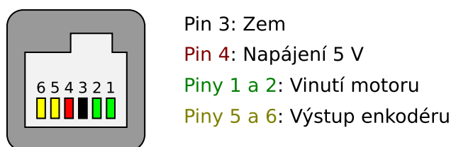
Obrázek 2.10: Funkce pinů v konektoru motoru.
